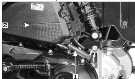
(1) Tubo de drenaje
