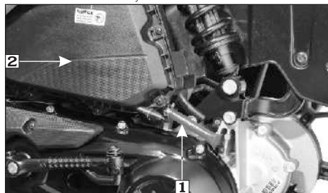
(1) Tubo de drenaje
