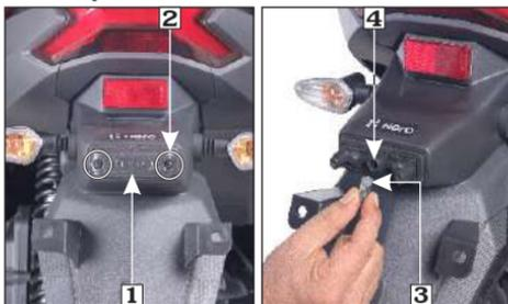
**(1) Cubierta de la luz de la placa**    **(2) Tornillos**    **(3) Bombillo**    **(4) Soporte**
