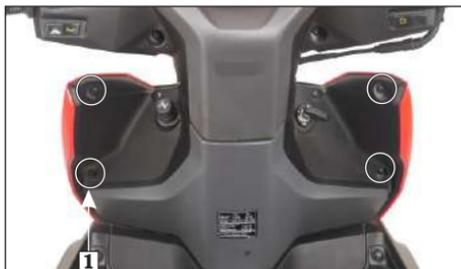
(1) Tornillos de la cubierta superior delantera
