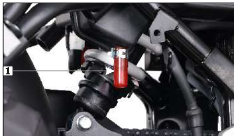
(1) Tubo de drenaje
