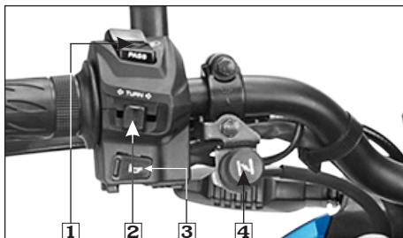
(1) Regulador de intensidad /de paso (2) Interruptor direccional (3) Interruptor de bocina (4) Palanca del choque
