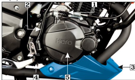
(1) Cable del embrague (2) Pedal de arranque (3) Cubierta del motor (4) Tope de patada (5) Cubierta del cárter derecho
