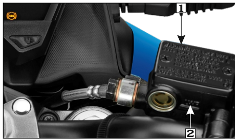
(1) Cilindro maestro (2) Marca MIN
