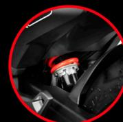
Mono amortiguador ajustable en 7 posiciones
