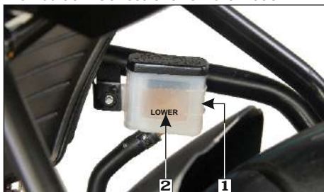
(1) Depósito (2) Marca "LOWER"
