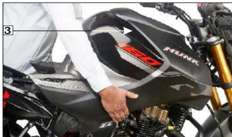
(3) Cubierta del tanque de combustible
