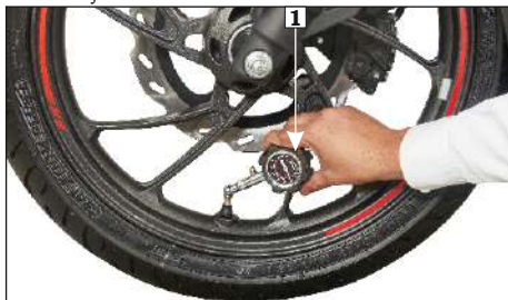
(1) Indicador de presión de aire
