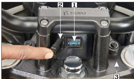
(1) Cargador USB (2) Tapa (3) Puente
