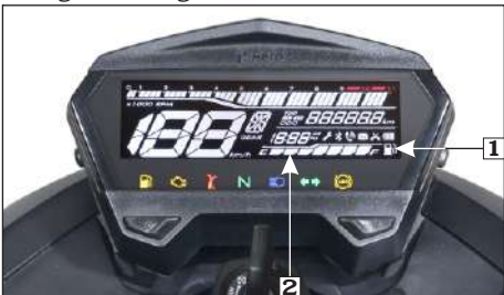
(1) Indicador de combustible (2) Segmentos
