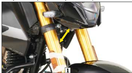
(1) Perno de ajuste de la luz principal
