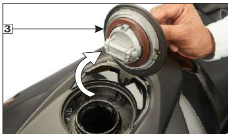
(3) Tapa del tanque de combustible
