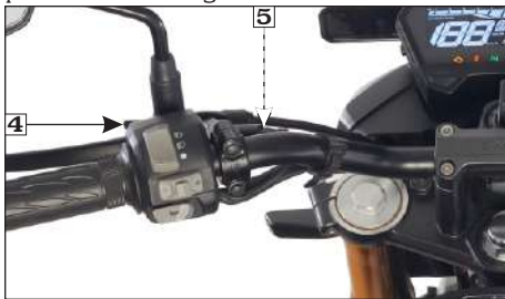
(4) Interruptor de paso (5) Int. de embrague
