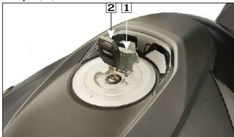
(1) Tapa del orificio de la llave (2) Llave
