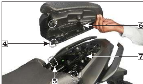
(4) Pestañas (5) Ranuras (6) Gancho (7) Pestillo del asiento
