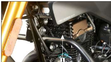
(1) Enfriador de aceite del motor
