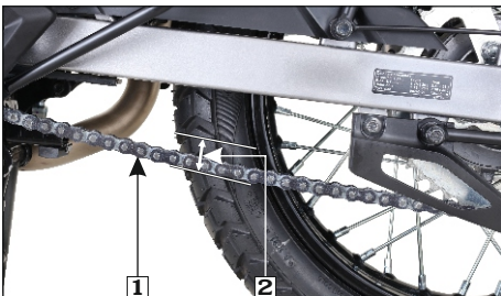
(1) Cadena de transmisión (2) Holgura: 30-35 mm
