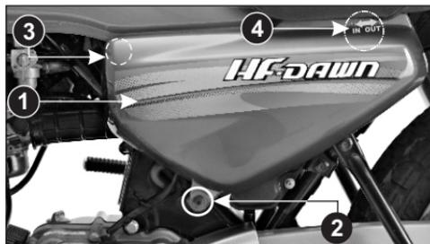
(1) Cubierta lateral (2) Tornillo de la cubierta lateral (3) Oreja (4) Indicador de dirección
