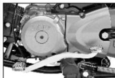
3. Encuentre la posición neutra y revise si el indicador (N) brilla en el grupo de Instrumentos con el encendido en "ON"
