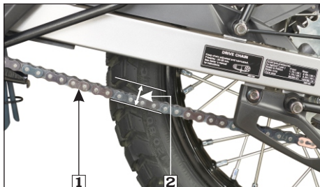
(1) Cadena de transmisión (2) Holgura: 30-35 mm
