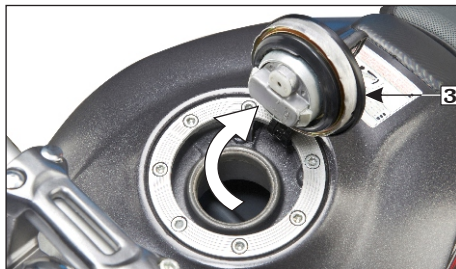
(3) Tapa tanque de combustible
