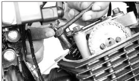
(5) Calibrador (6) Tornillo de ajuste (7) Vástago de la válvula (8) Tuerca bloqueo
